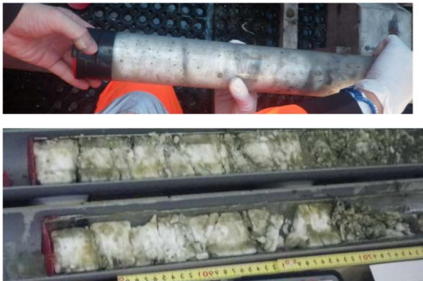
図8 船上からの掘削によって回収された塊状メタンハイドレート
